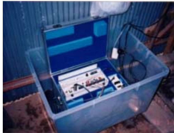
写真 8 有線テレメータ送量装置
