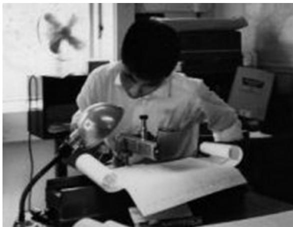
写真3 読取器 (コンパレーター)
