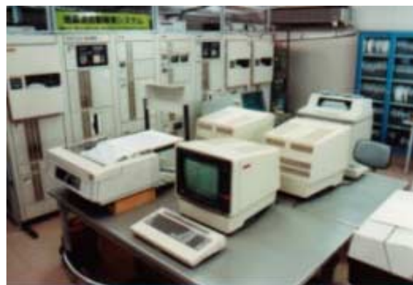
写真6 地震波自動検測システム
