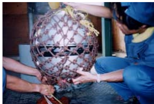
図 11 . 破壊した球殻
