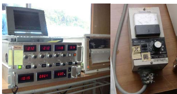
写真3 HFLS収録システムとコントローラー
