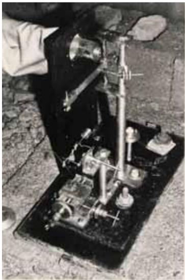
写真 1 光学式伸縮計増幅部
