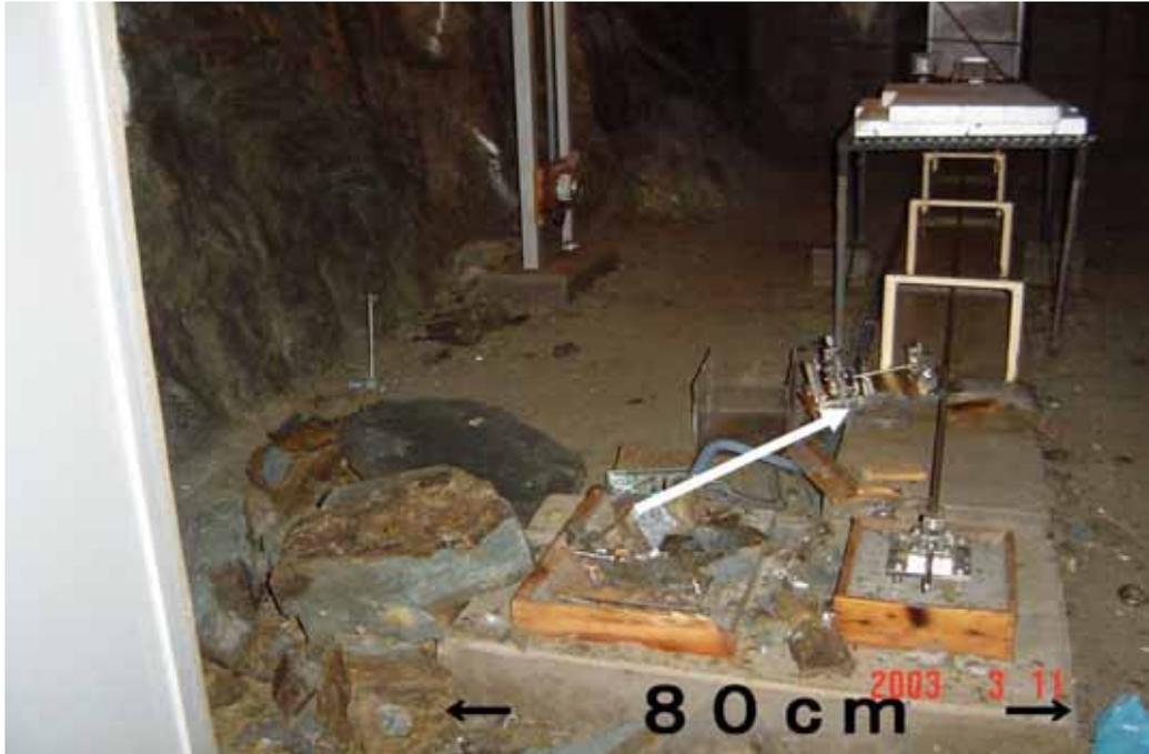
写真5 落石及び破壊された観測計器
