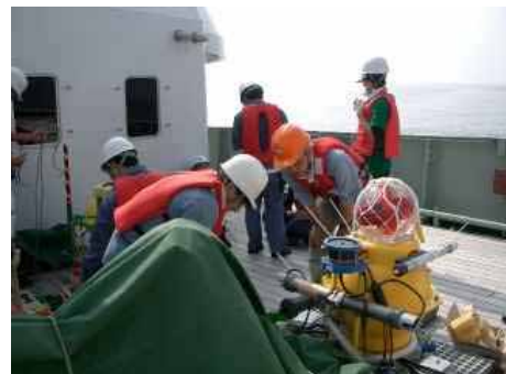
写真 4 OBEM : M100A, B, C (短周期海底電位差計)
