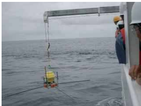
写真 3 OBE : KPC-E (短周期海底電位差計)
