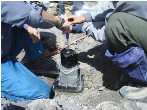
写真9 水管傾斜計
