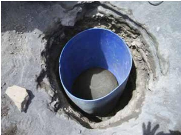
写真5 地震計台と保護管
