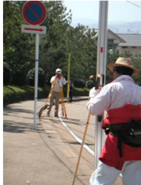
写真10 水準測量風景
