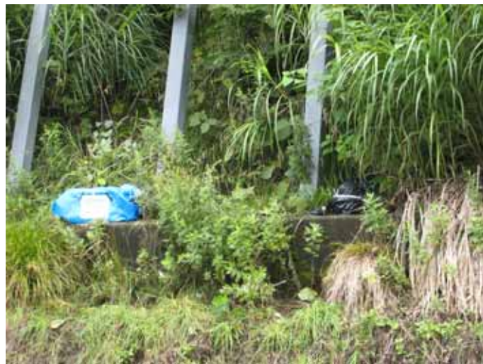
写真 1 地震計設置状況 1 (黒袋で覆われているのが地震計, ブルーシートで包んでいるのがデ-
