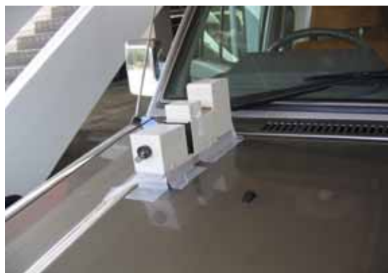
写真2 火山ガス測定の分光器を公用車に取り付けた様子
