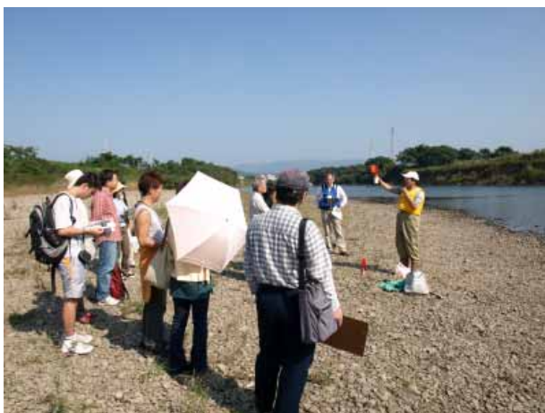
浮子を流して流速を測る (宇治川に何回か流して計測する)
