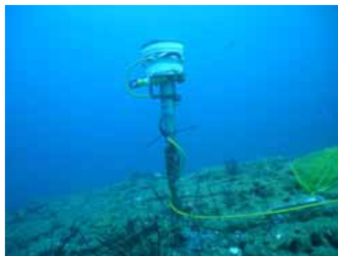
写真4 ADCP 設置完成写真
