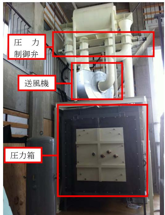
写真 1 圧力載荷実験装置
