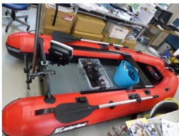
写真 4: 河床地形観測用のゴムボートと測器
