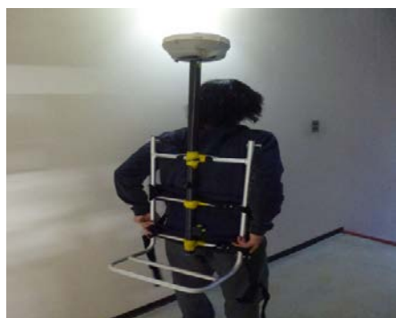
写真 2：背負子にセットした測器
