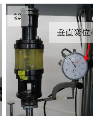
③⑩ ストッパーをひねりながら垂直载荷用アクチュエーターを下げ、アクチュエーターと荷重トルク検出器を三本のボルトでつなぎます。
