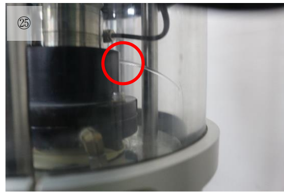
②⑤ 供試体上部から水が流れ出したら、三軸室(中)のバルブを閉じます。
