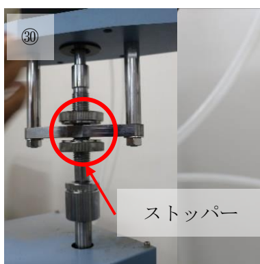
③⑩ ストッパーをひねりながら垂直载荷用アクチュエーターを下げ、アクチュエーターと荷重トルク検出器を三本のボルトでつなぎます。
