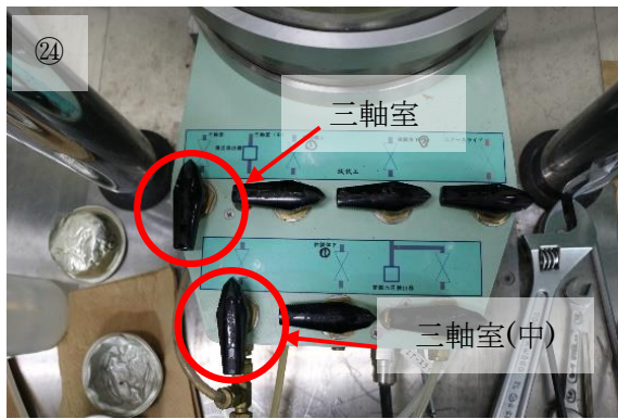
②④ 三軸室と三軸室(中)のバルブをひねり、セル内に脱気水を供給します。
