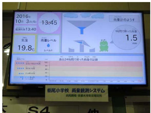
写真2 雨量観測モニター
