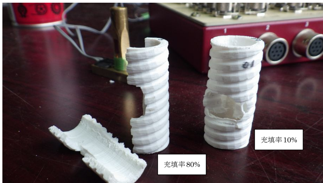
図 5. 試験片破損状況
