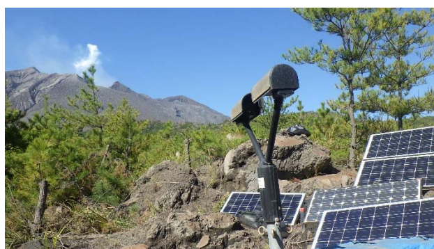
図1. ディストロメータの設置状況
