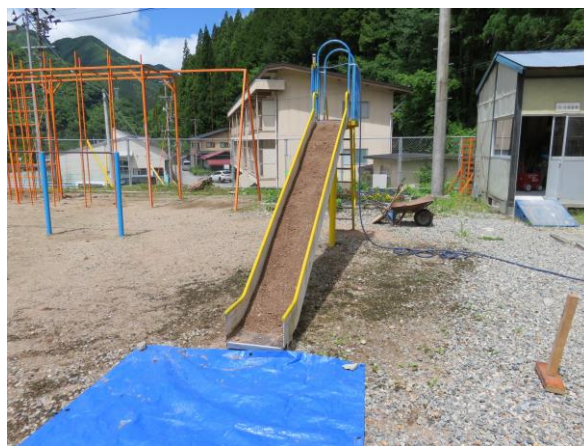
写真1 滑り台での斜面崩壊・土石流実験
