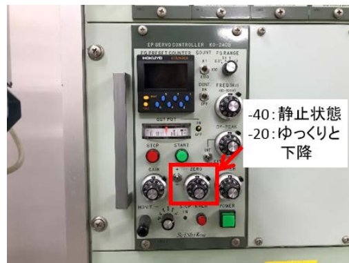
垂直載荷用アクチュエーターのパネル
