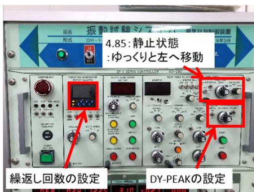
ねじり载荷用アクチュエーターのパネル
