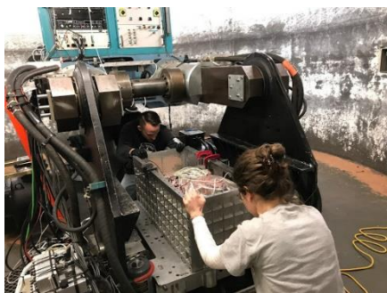
図 4. 試験体を遠心に設置する様子
