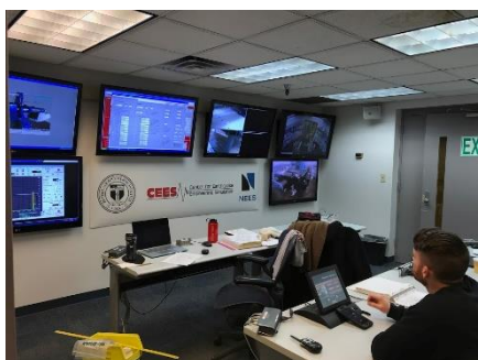
図 6. 制御室。モニター6台のうち監視用3台、計測 PC 用、遠心操作用、CPT 操作用として使用
