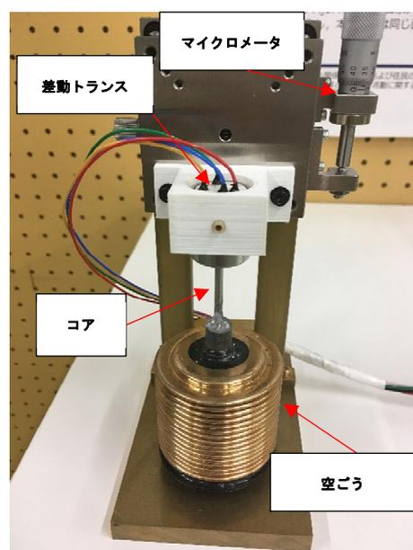
図2 製作した気圧計
