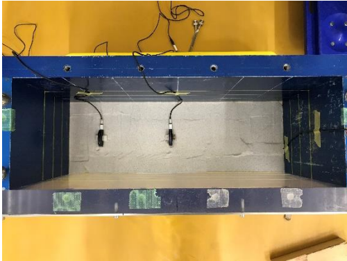
ベンダー設置状況 1
