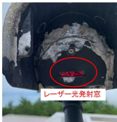
図.5 レーザー光発射窓に水滴が付着している様子
