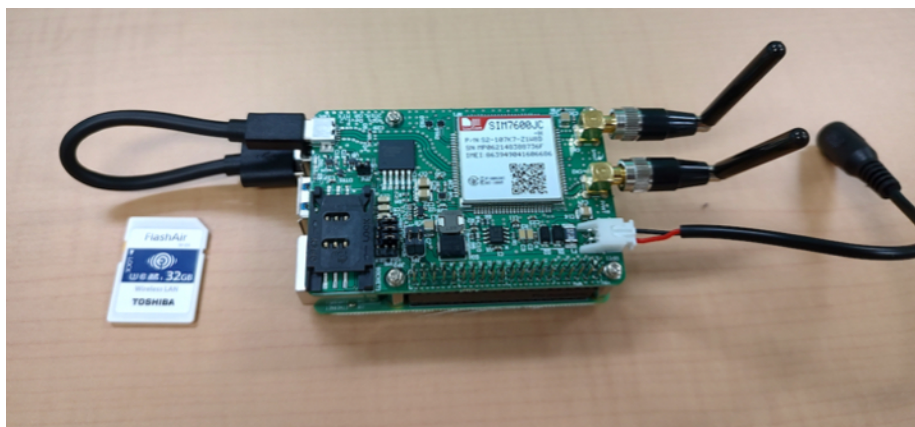
写真 1. FlashAir と 4GPi を搭載した Raspberry Pi
